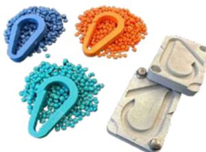
> Ce moule usiné en aluminium permet d'injecter des goodies en forme de mousqueton.
